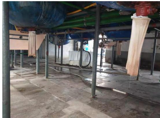
二车间：酸化结晶，二乙酸母液浓缩，二乙酸粗品精制。地面已硬化，无明显破损，具备防渗功能；生产设备周围地面较为整洁，无原料泄露；车间四周设有导排沟，各类管道、法兰
