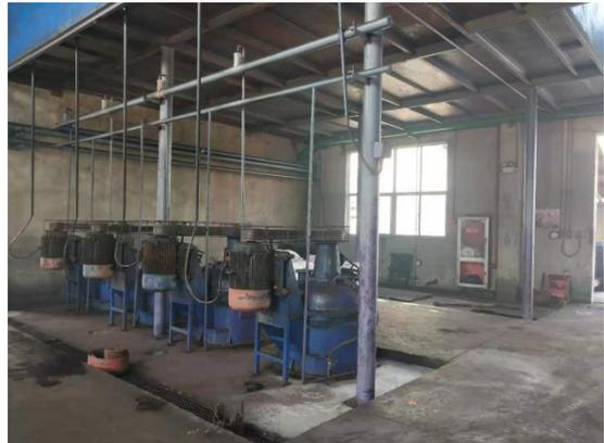
永固紫球磨车间：粗品永固紫紫研磨颜料化和粉碎干燥。地面已硬化，无明显破损，具备防渗功能；生产设备周围地面较为整洁，无原料泄露；车间四周设有导排沟，各类管道、法兰和泵等均保养完好，法兰、阀门和管道连接良好，无滴漏。
