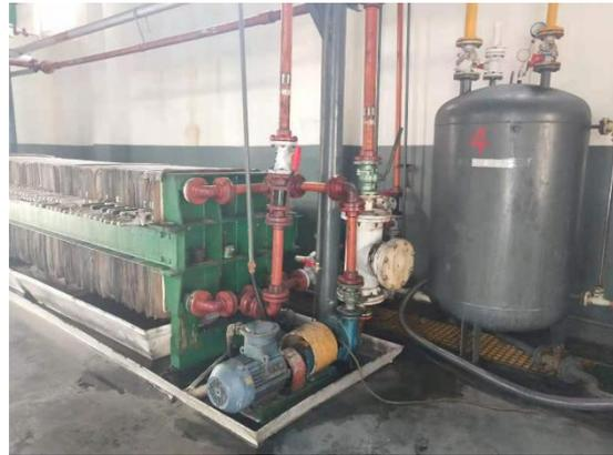
一车间：亚氨基二乙腈水解，一次酸化生成亚氨基二乙酸钠盐。地面已硬化，无明显破损，具备防渗功能；生产设备周围地面较为整洁，无原料泄露；车间四周设有导排沟，各类管道、法兰和泵等均保养完好，法兰、阀门和管道连接良好，无滴漏。
